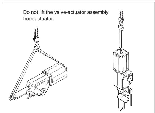
Fig. 6 Lifting the actuator
